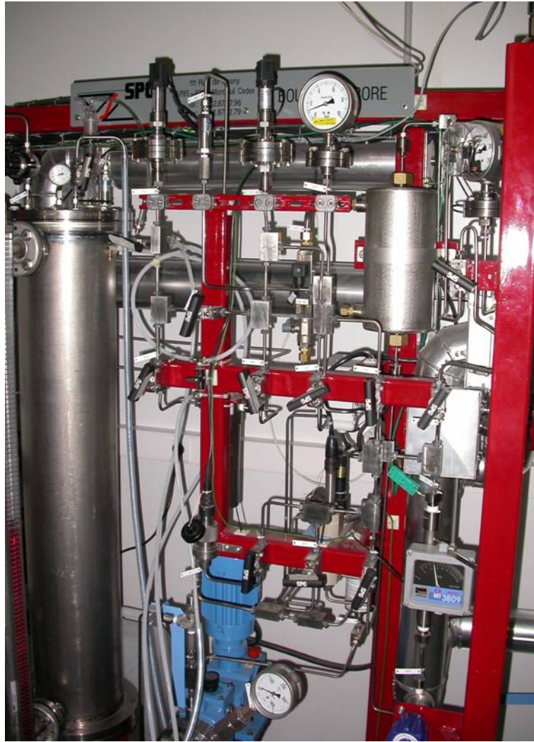
FIGURE 6.4 – Photographie de la boucle en titane contenant le fluide en circulation dans le simulateur Aurore électrochimie
