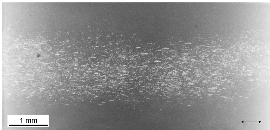
FIGURE 7.3 – Tube JP3 (304L, pH 6.9) : trace de frottement localisée sur la partie centrale du tube
