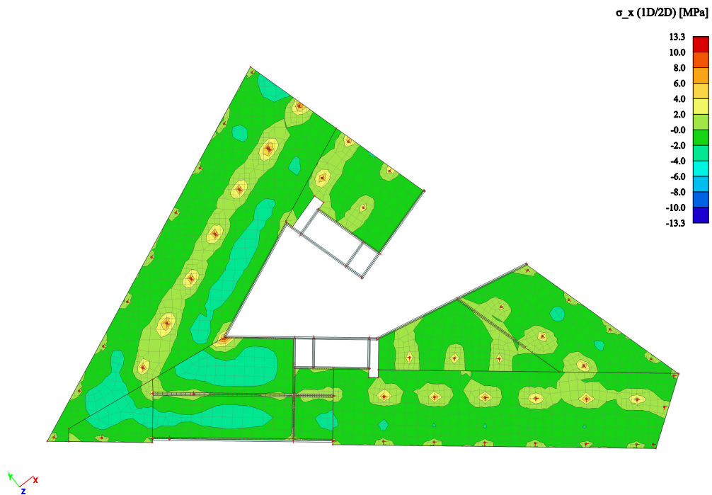
FIGURE 59 – Contraintes de flexion : sens porteur : CLT isotrope
